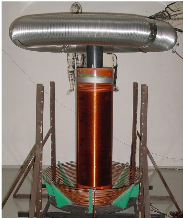
Im obersten Teil der Spule, wo die Spannung am größten wird, sind die Windungen in etwas größeren Abständen gewickelt, um Überschläge zu vermeiden. Das untere Ende der Spule ist geerdet. Damit ergibt sich unten ein „Strombauch“ und ein „Spannungsknoten“, oben hingegen ein „Stromknoten“ und ein „Spannungsbauch“, der uns am Torus die Hochspannung liefert.
